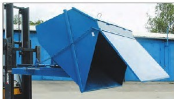
Prosta i bezpieczna obsługa z miejsca operatora. Samoczynne otwieranie pokrywy.
