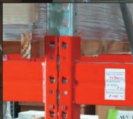
Szczegóły łączenia belki ze słupkiem.
