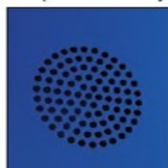
Podwójne dno służy do oddzielenia stałych części od cieczy.
