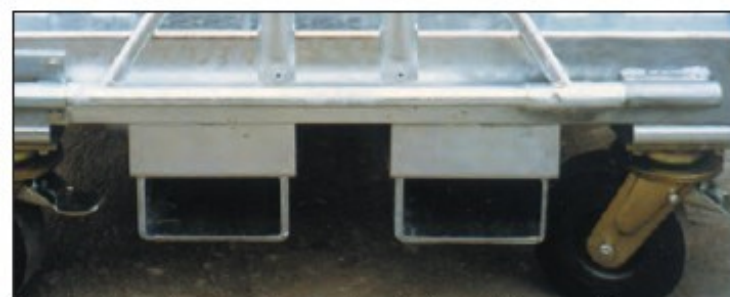
Szczegóły adapteru do manipulacji wózkiem widłowym.
