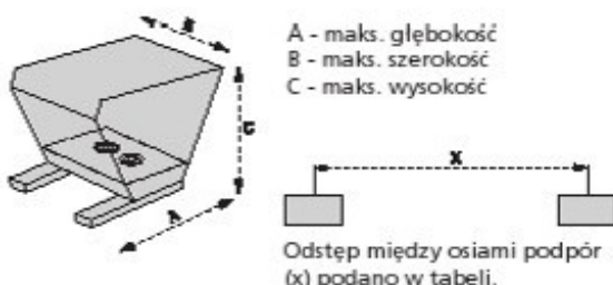
Podwójne dno służy do oddzielenia stałych części od cieczy.
